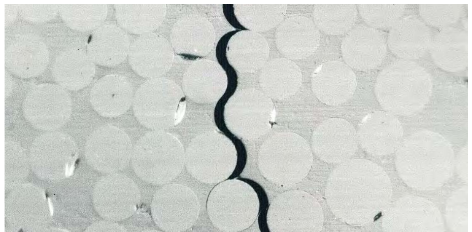
Transversell spricka i glas berarmerad vinylester. Sprickan uppstod vid låg töjning (< 0.2%) på grund av dålig vidhäftning mellan fibrerna och plasten.
