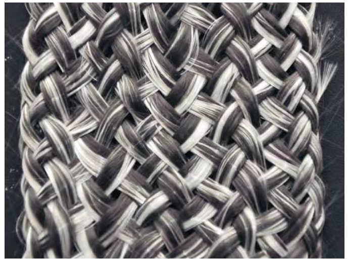
Flätad strumpa bestående av en kombination av glas fiber och polypropen fiber (hybridgarn).
