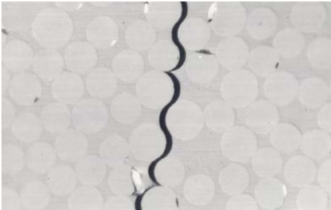
Transversell spricka i glas berarmerad vinylester. Sprickan uppstod vid låg töjning (< 0.2%) på grund av svagt fäste mellan fibrerna och plasten.
