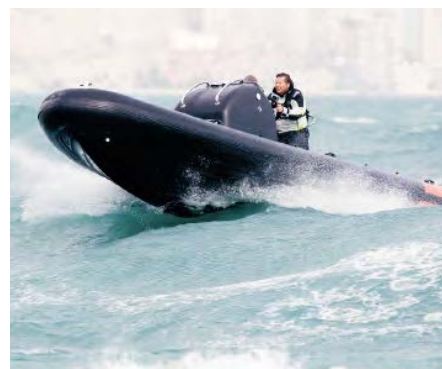
RIB båt med skrov tillverkat av kol berarmerad epoxi.
