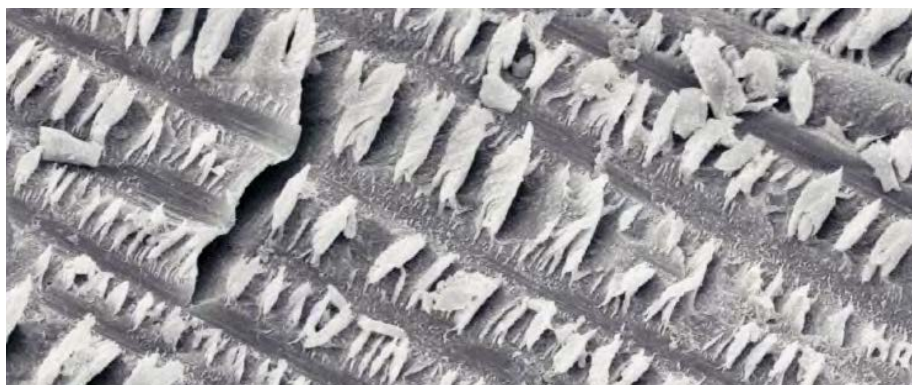
Brottyta i kol berarmerad epoxi. Delamineringsprickan har tillväxt under skjuvbelastning.
