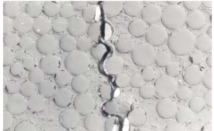
Transversell spricka i glas berarmerad vinylester. Sprickan uppstod vid hög töjning (> 0.6%) tack vare starkt fäste mellan fibrerna och plasten.
